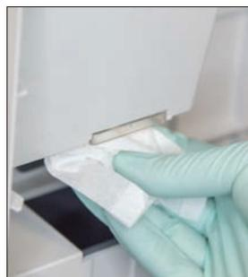
2. Die Tür des Analysegeräts öffnen und Ober- sowie Unterseite des Messfensters mit einem mit warmem Wasser angefeuchteten optischen Reinigungstuch reinigen. Anschließend mit einem neuen trockenen optischen Reinigungstuch trocknen.
