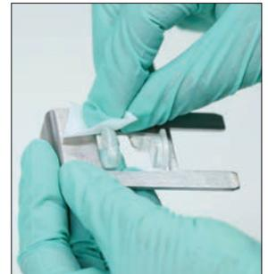
3. Den Kartuschenhalter entfernen, mit einem Alkoholtupfer reinigen, mit einem optischen Reinigungstuch trocknen und anschließend beiseitestellen.
