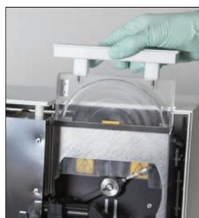
7. Die Schutzabdeckung der Zentrifuge, den Abfallbehälter und die Tropfschale entfernen. Anschließend mit warmem Wasser reinigen und mit Papiertüchern trocknen.
