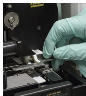
9. Abfallbehälter, Tropfschale, Schutzabdeckung der Zentrifuge und Kartuschenhalter an den entsprechenden Stellen wieder in das Analysegerät einsetzen.
