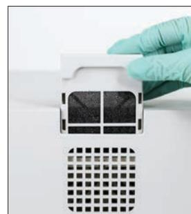
10. Den Lüfterfilter auf der Rückseite des Analysegeräts herausnehmen, gründlich mit warmem Wasser abspülen, mit einem Papiertuch trocken tupfen und wieder an seinen Platz im Analysegerät einsetzen.
