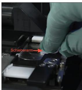
4. Reinigen Sie die linke Seite des Schieberarms fünfmal mit einem neuen, gespülten Alkoholtupfer (stellen Sie sicher, dass der rechte Rand der Führung gründlich gereinigt wird) und trocknen Sie ihn dann mit einem neuen trockenen optischen Reinigungstuch ab.
