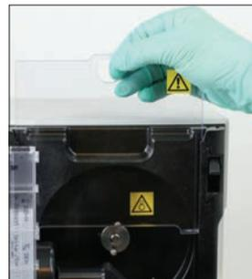
6. Entfernen Sie die Abschirmung der Zentrifuge und den Abfallbehälter. Beides mit warmem Wasser reinigen und mit Papiertüchern trocknen.
