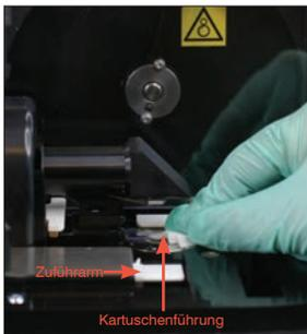
4. Reinigen Sie die Kartuschenführung und den weißen Zuführarm gründlich mit einem neuen Alkoholtupfer. Anschließend beides mit einem optischen Reinigungstuch trocknen.
