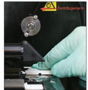
7. Bewegen Sie den Zentrifugenarm vorsichtig nach links und überprüfen Sie den Bereich darunter auf Verschmutzungen. Wenn der Bereich verschmutzt ist, verwenden Sie einen frischen Alkoholtupfer, um ihn zu reinigen, und trocknen Sie ihn dann mit einem neuen optischen Reinigungstuch.
