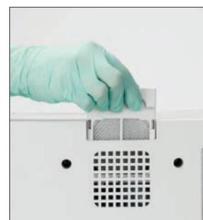
10. Den Lüfterfilter herausnehmen, gründlich mit warmem Wasser abspülen, mit einem Papiertuch trocken tupfen und wieder an seinen Platz im Analysegerät einsetzen. Tippen Sie anschließend im Bildschirm SediVue Dx Cleaning Guide auf **Erläutigt** zum Einschalten des SediVue Dx.
