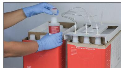
5. Platzieren Sie den Schnellkupplungsaufsatz auf dem Reagenzienkit. Stellen Sie dabei sicher, dass die Schlauchenden in die 3 Reagenzienflaschen, das Systemverdünnungsmittel und den Abfallbehälter eingeführt werden.
