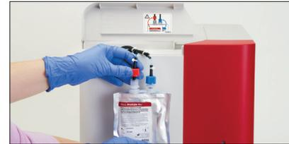
4. Setzen Sie die Färbemittel-Packung aufrecht in das Färbemittelfach ein und stellen Sie dabei sicher, dass sich die Schläuche im Inneren des Fachs an der Vorderseite der Färbemittel-Packung befinden und dass die Färbemittel-Packungen nicht gequetscht werden. Schließen Sie dann die Abdeckung.
