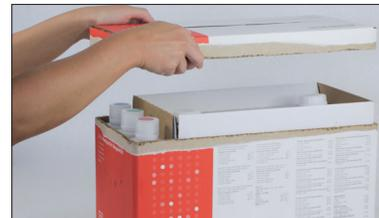
4. Entfernen Sie die Kappen von den 3 Flaschen, dem Systemverdünnungsmittel und dem Abfallbehälter (verwenden Sie hierfür ggf. den Kappenentferner aus dem Originalzubehörkit) und legen Sie diese beiseite. Vergewissern Sie sich, dass die Reihenfolge der Flaschen korrekt ist, indem Sie die Farben auf den Flaschenetiketten jeweils mit den Farben im Reagenzienfach abgleichen.
