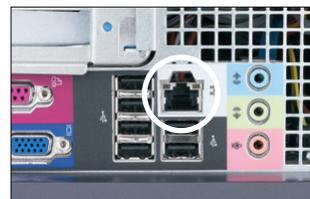
Ethernet-Anschluss auf der Rückplatte des Hauptprozessors (CPU) des Computers der IDEXX VetLab Station
